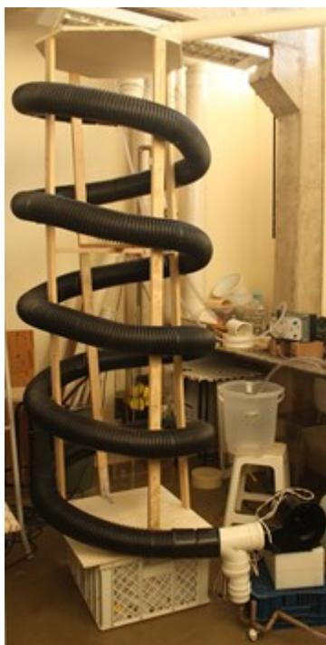
**Figura 1: Fotografia do sistema de remoção de nitrogênio com 20% de declividade: (1) reservatório de alimentação; (2) bomba dosadora eletromagnética; (3) entrada da água residuária; (4) tubo corrugado helicoidal 4"; (5) soprador de ar; (6) saída da água residuária.**
